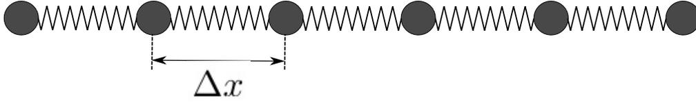
FIGURE 9 – Chaîne linéaire d'oscillateurs identiques.
